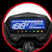
Indicador de posición en marcha y testigo de pata
